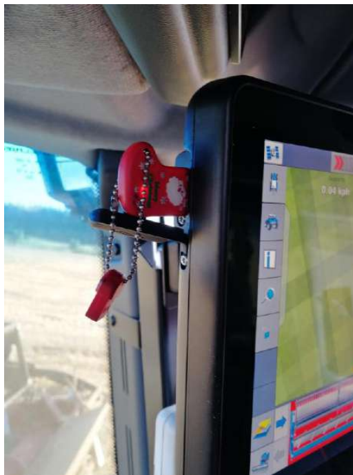
Рисунок М35 - Место установки флеш карты
