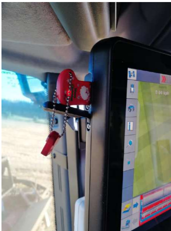
Рисунок М29 - Место установки флеш карты
